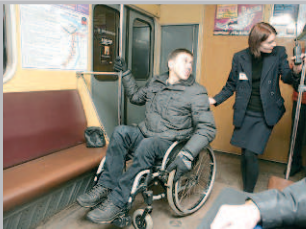
За Международния ден на инвалида, отбелязван на 3 декември, в метрото на Нижни Новгород се появи специално съоръжение за облекчено придвижване на инвалидните колички. То се прикрепва към колелата и се спуска безпрепятствено по стълби и преминава през прагове благодарение на монтираните "гъсеници" на принципа на движението на танковете. Някои нарекоха съоръжението "подземен луноход". Услугата за хората с ограничени възможности и безплатна
