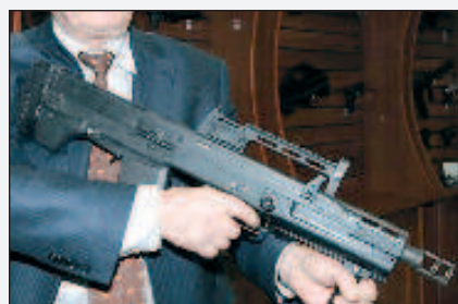
НПО "Ижмаш", где собирают АК начнет выпускать оружие по схеме "булл-пап", при которой ударный механизм и магазин расположены позади спускового крючка
