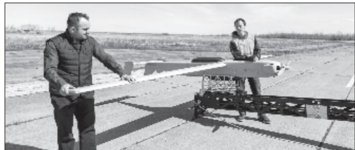
Новата разработка "Фотон" не зависи от навигационните системи тип GPS и ГЛОНАСС. Неговата автономност се осигурява от вградения алтернативен навигационен блок, създаден от самарските учени. Този блок е основан на принципите на оптичната навигация. Благодарение на опорните точки, предварително зададени по маршрута, безпилотникът може да се ориентира в местността с помощта на "техническо зрение" и да коригира курса, без да се използват спътникови навигационни сигнали.
