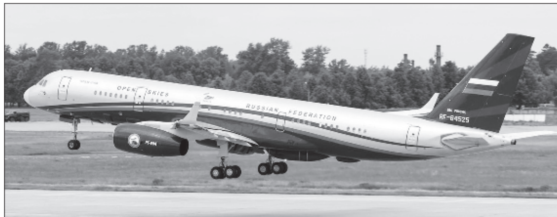
Руският самолет Ту-214ОН, използван за полети в рамките на Договора "Открито небе"
