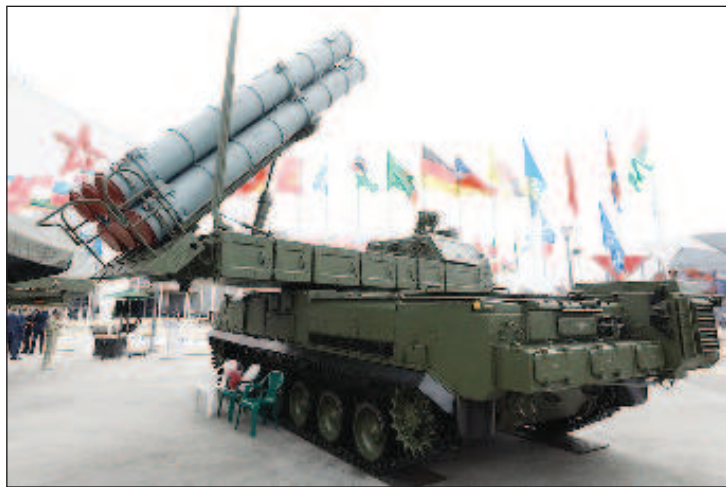
Самоходната огнева установка СОУ 9А317М от зенитно-ракетния комплекс ЗРК 9КЗ17М "Бук-М3"
