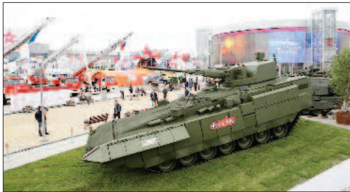
Бойна бронирани верижна машина Т-15 на базата на универсалната верижна платформа "Амата"
