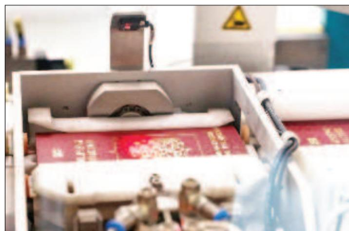
освещения, устройство, сочетающее сканер MRZ-строки (машинно-читаемой зоны) и считыватель микросхем паспортов. Новая разработка упростит процесс обработки и выдачи документов, обеспечит надежную защиту персональных данных пользователей. Предоставляемые
